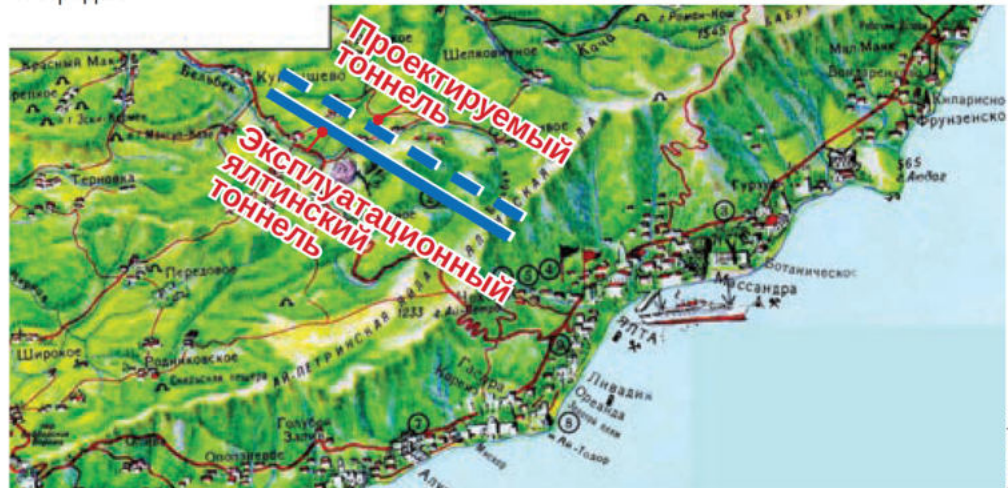
Гидротехнический тоннель, выполняемый методом щитовой проходки, пройдёт через Ялтинский горный массив.
