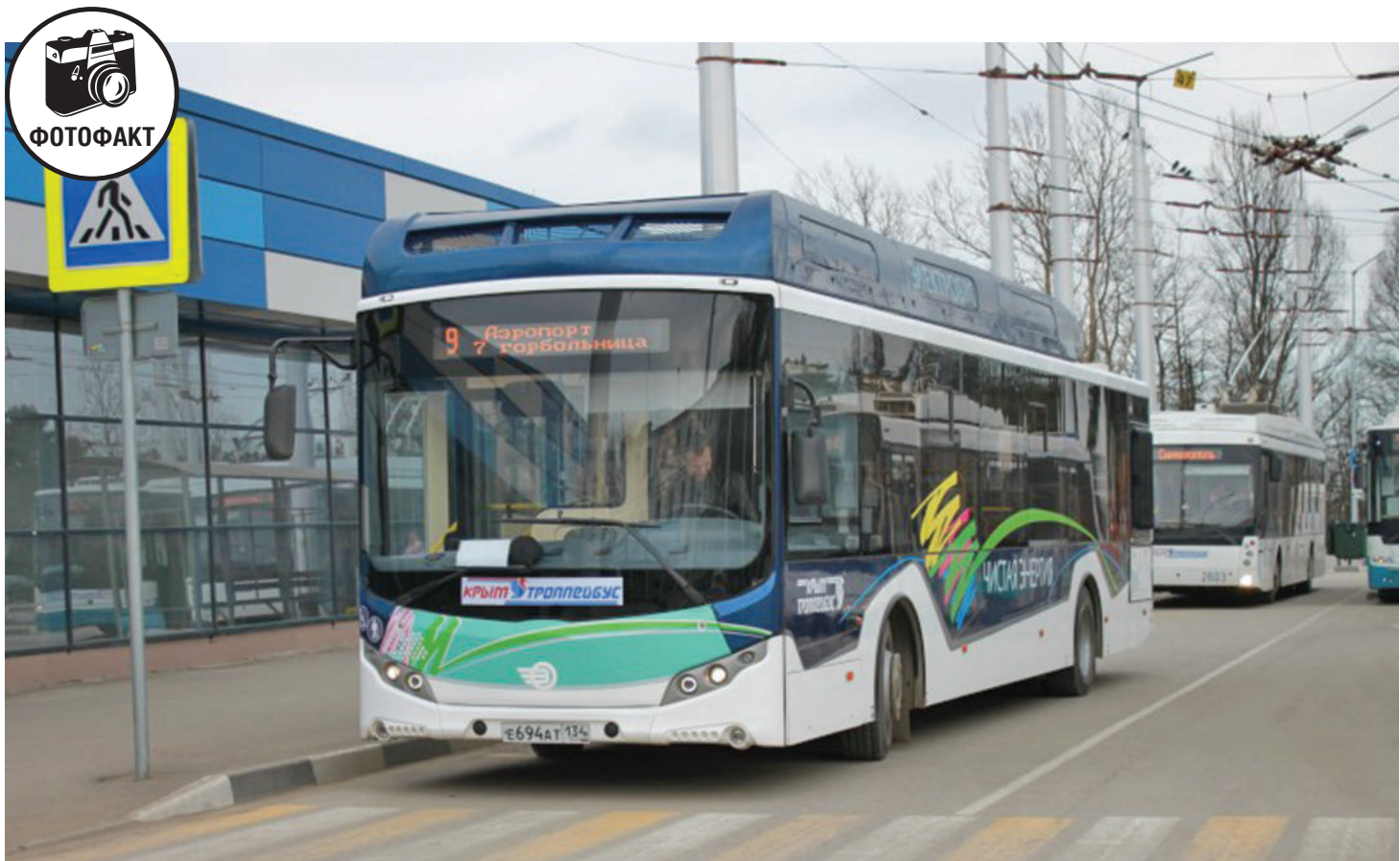
На улицы Симферополя вышел первый электробус марки Volgabus («Волгабас»). Пока его тестируют. Автобус оснащён литий-полимерными батареями, которые заряжаются в течение четырёх часов. От одного заряда он способен проехать до 250 км. Фото: пресс-служба ГУП РК «Крымтроллейбус»
