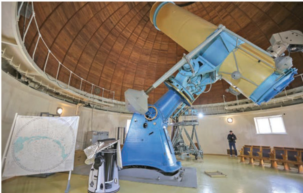
Одному из звёздных телескопов Крымской астрофизической обсерватории более 100 лет. 50-сантиметровый (по размеру зеркала) телескоп, произведённый в Германии и прибывший в Союз после окончания Второй мировой войны, долгое время был одним из крупнейших в Европе. Оптика до сих пор в идеальном состоянии, рассказывают сотрудники, однако физический износ старой механики больше не позволяет работать. Восстановить его – мечта крымских астрономов.
