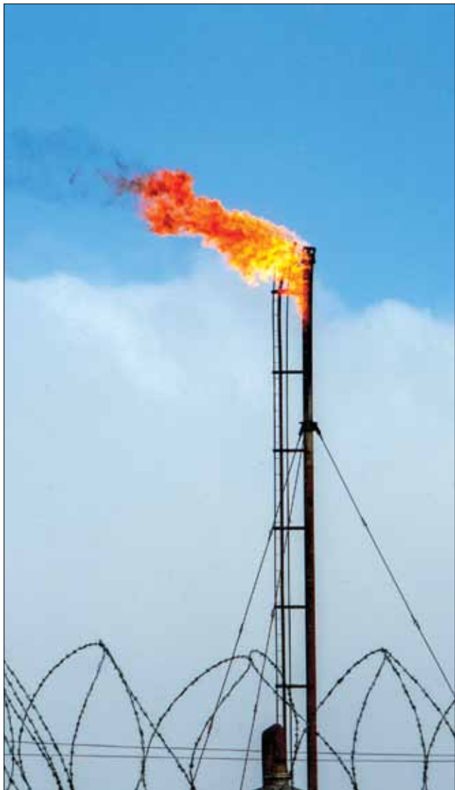
Это не «газ на ветер». Это технологический процесс по дегазации конденсата.
