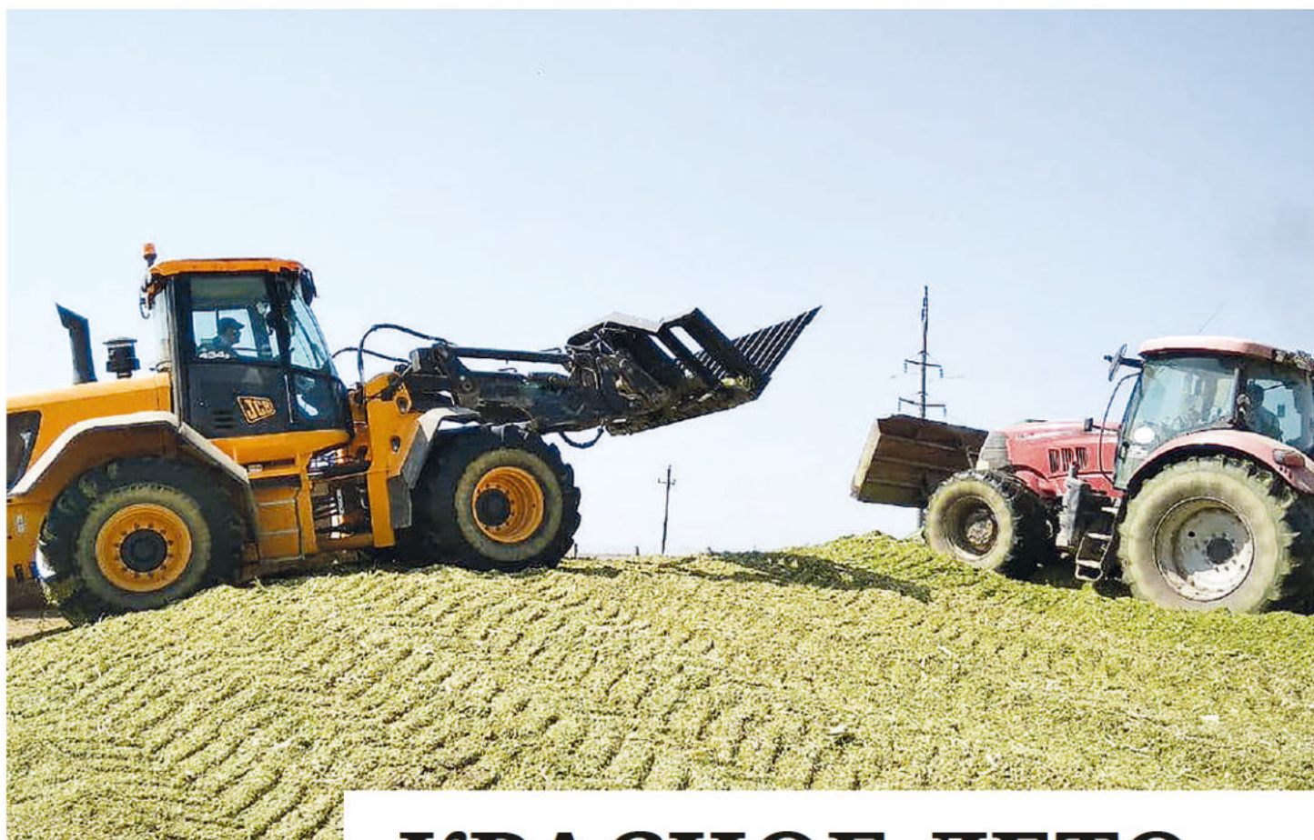
Трамбовка силоса необходима, чтобы удалить лишний кислород и обеспечить сохранность зелёного корма. Фото: Борис СЕДЕНКО
