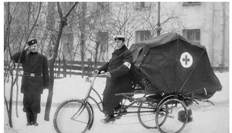
Крытая коляска «для пострадавших и рожениц», сделанная на основе велосипеда, 1912 г. miloserdie.ru
