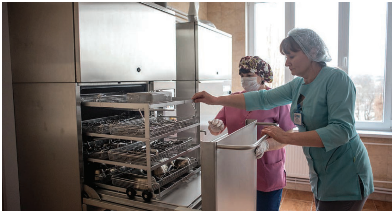
Так загружают инструментарий для предварительной очистки перед стерилизацией. Фото: Антон ВОЛК
