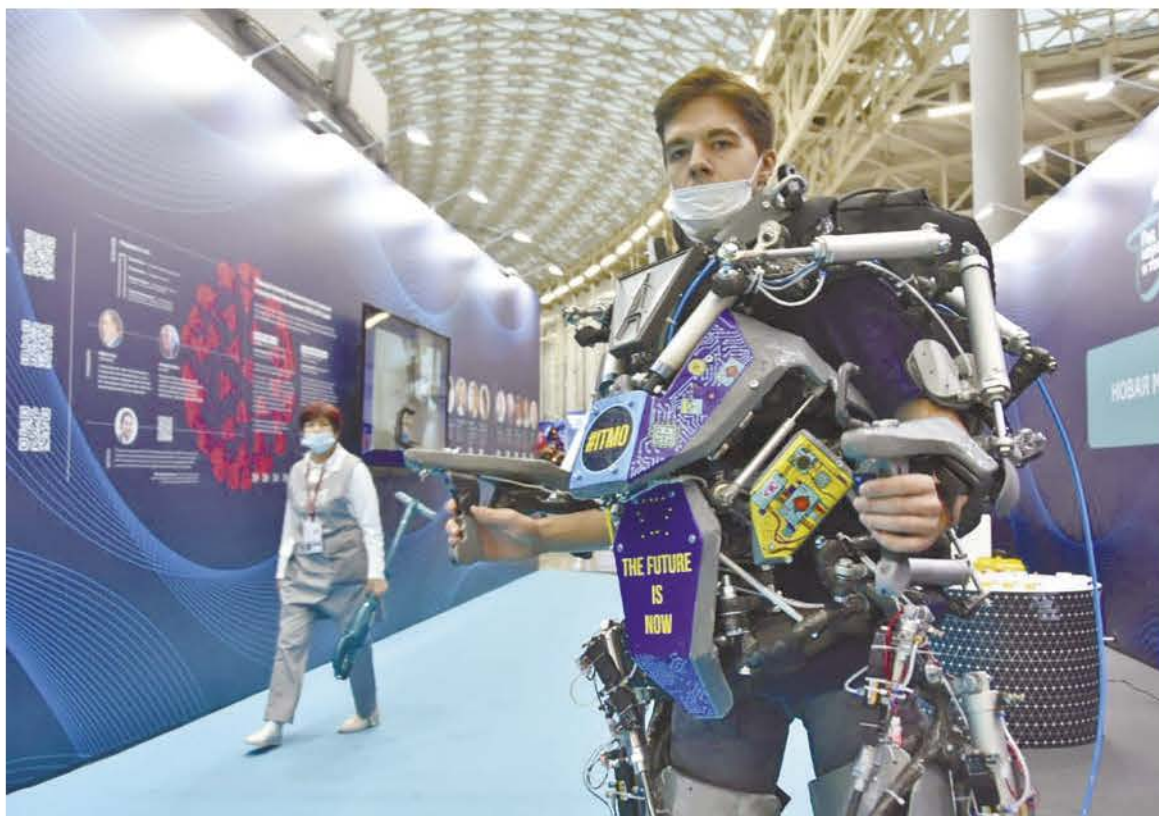
Экзоскелет, который позволяет поднимать грузы до 80 кг.
